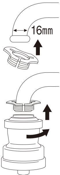
※切替の際、水栓取付部がゆるむことがありますので、定期的に締め直してください。
