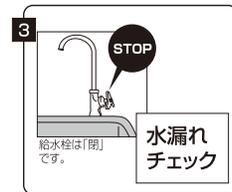
※「放流用止水栓」を取り付けの場合、通水と水漏れチェックは「放流用止水栓」で行なってください。
