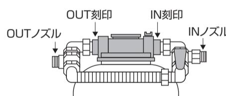
**!** 配管作業時は接続部にパッキンが取り付けられていることを必ず確認してください。
