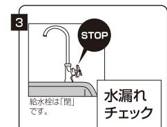
※放流用止水栓を取り付けの場合、通水と水漏れチェックは「放流用止水栓」で行なってください。
