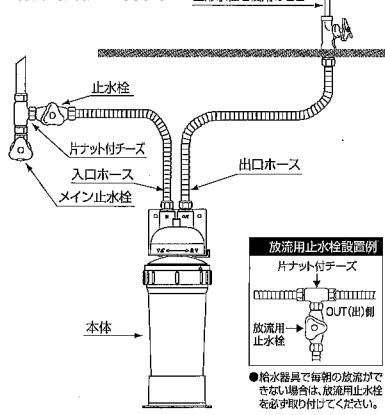
●給水器具で毎朝の放流水ができる場合、放流水止水栓を必ず取り付けてください。
